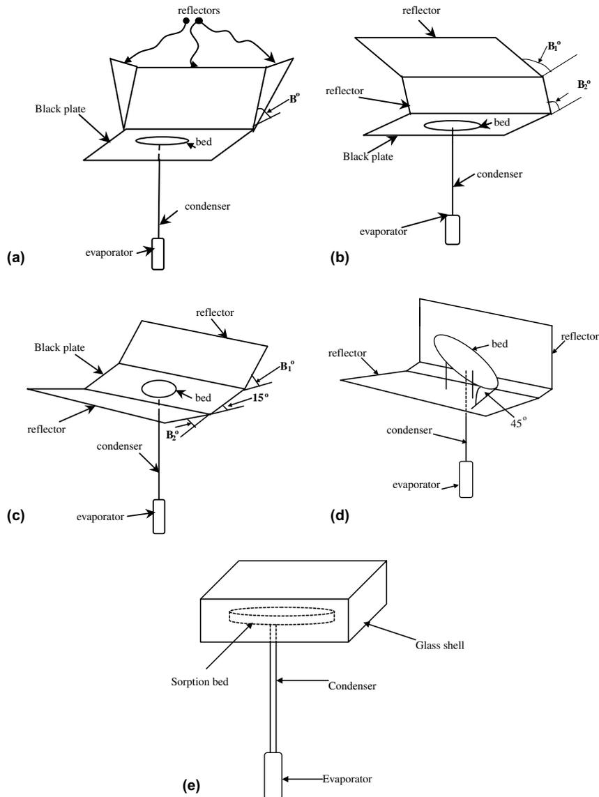
Fig. 4. Reflector arrangements: (a) Type A, (b) Type B, (c) Type C, (d) Type D, (e) glass shell.
